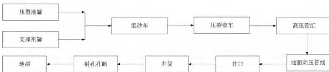
图 3.2-3 压裂施工时液体流动过程
