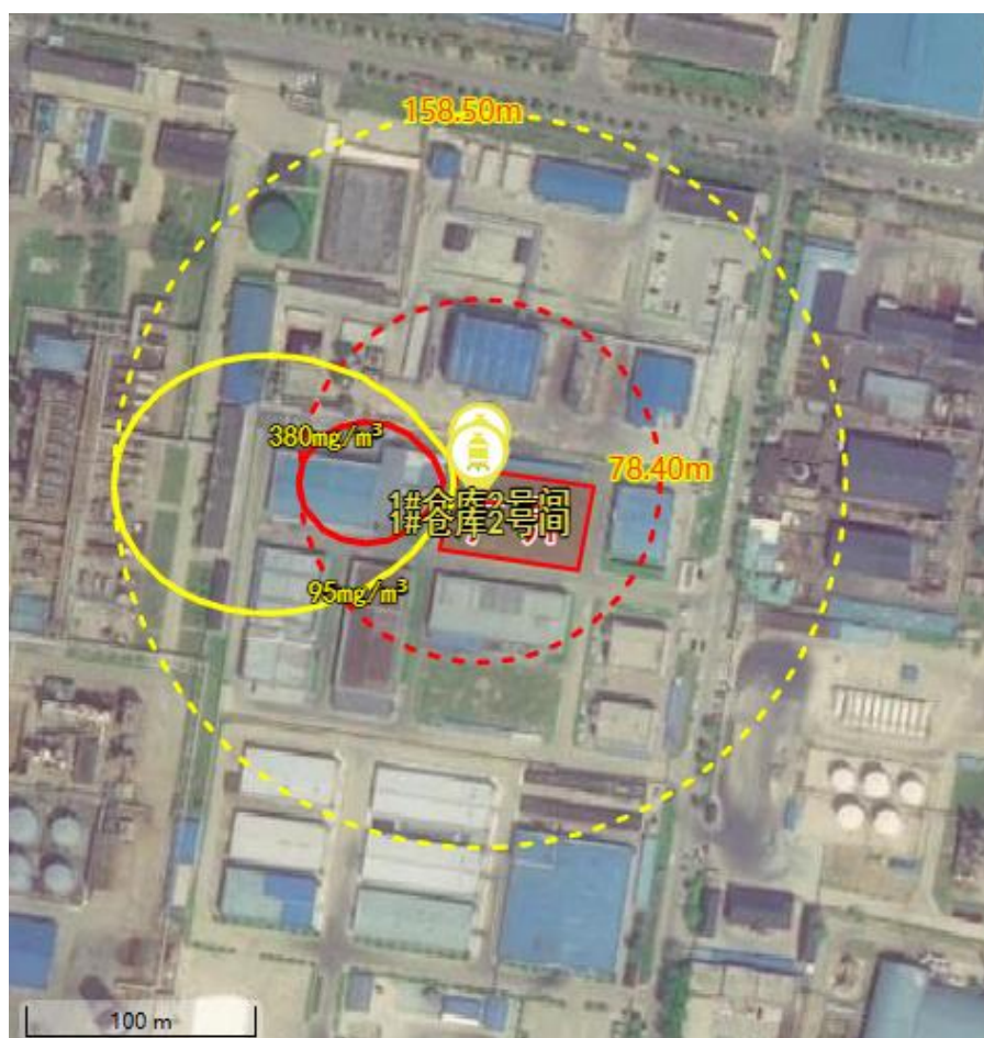
图 6.1-4 受热分解事故发生后 CO 阈值最大影响范围图
