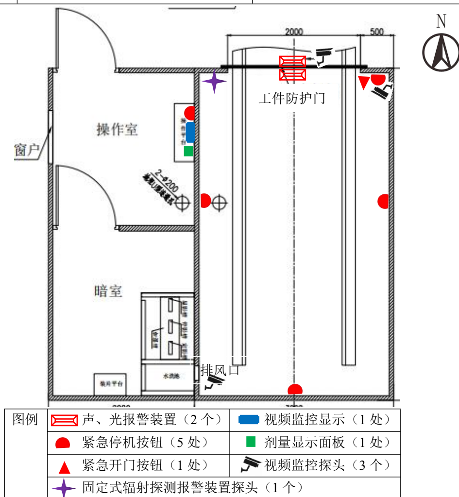
图 10-2 本项目探伤室安全防护设施示意图
