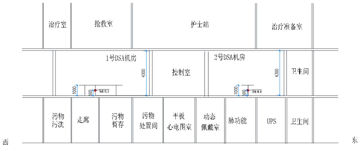
图 10.5 本项目两间 DSA 机房剖面示意图
